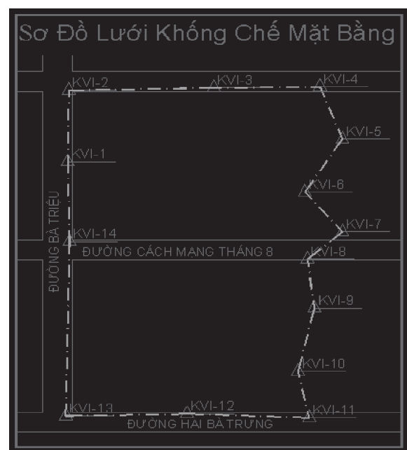
Hình 3. Sơ đồ lưới khống chế mặt bằng
